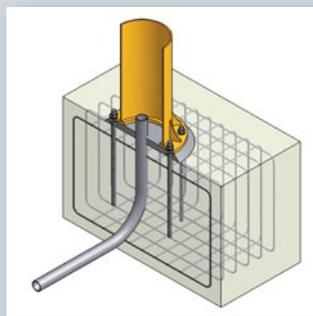
Die klassische Fundamentbefestigung mit Ankerschrauben, Schablone und einem Satz Muttern und Scheiben. Zur Lieferung gehört des Weiteren ein ausführlicher Fundamentplan mit Angaben zur Fundamentgröße und Bewehrung.
