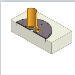
Die innovative Lösung zur Verdübelung des Säulenschwenkkranes auf vorhandenem Betonboden. Aufwändige Fundamentierungsarbeiten entfallen. Detaillierte Informationen siehe Seite 38 - 39.
