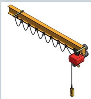
Günstige Stromzuführung, bestehend aus Rundkabel, Kabelwagen, Spannseil und Haltearmen zur Befestigung am Ausleger. Kommandotafel am Hebezeug befestigt. Empfohlen bei einer Ausladung von 3-10 m\*.
