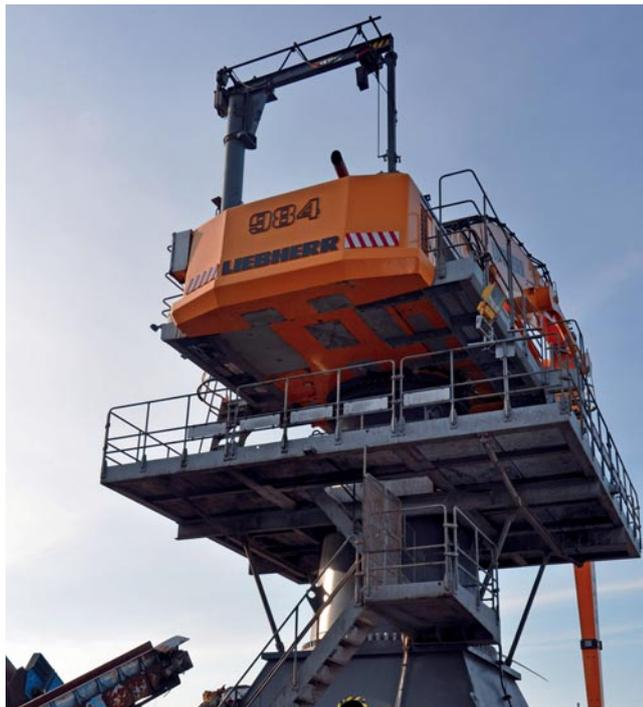
Wartungskran auf dem Gegengewicht eines Liebherr Hydraulikbaggers
