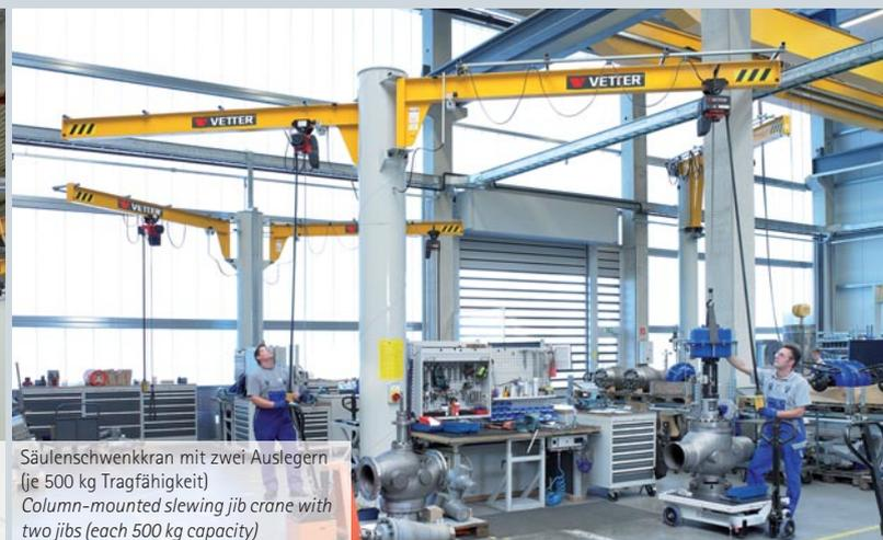
Säulenschwenkran mit zwei Auslegern (je 500 kg Tragfähigkeit)
