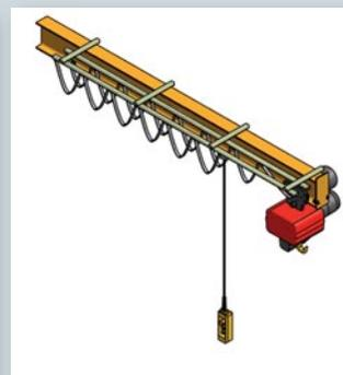
Die Kommandotafel wird an einer separaten C-Schiene unabhängig vom Hebezeug verfahren. Bestehend aus Flachkabel, Kabelwagen, Steuerwagen, zwei C-Schienen und Haltearmen. Besonders geeignet, wenn der Bediener einen Abstand zur Last halten muss, da diese über ein Hindernis / Grube geführt wird.
