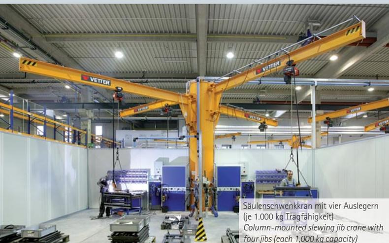
Säulenschwenkran mit vier Auslegern (je 1.000 kg Tragfähigkeit)
