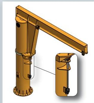
Zur Arretierung des Auslegers in mehreren Stellungen. Betätigung über Schubgestänge / Zugseil (je nach Krantyp) mit Bedienelement. Sie dient gleichzeitig als Windsicherung bis Windstärke 7 Beaufort (nur bei abgeschalteter Krananlage und Hebezeug in Ruhestellung).
