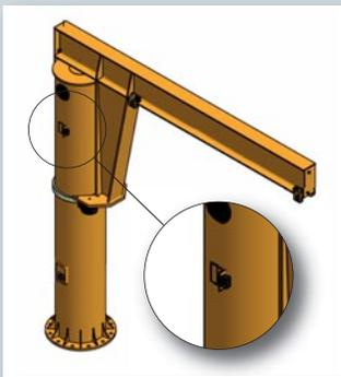
Mechanische Schwenkbegrenzung, anschweißbar / anschraubbar entsprechend den bauseitigen Gegebenheiten zur Begrenzung des Schwenkbereiches rechts / links.
