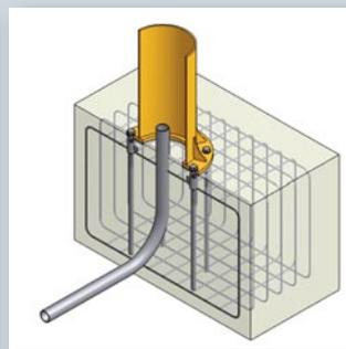
Die alternative Fundamentbefestigung ohne herausstehende Ankerschrauben (keine Stolperfallen). Bis zur Kranmontage bleibt die Fundamentfläche frei begehb- und befahrbar. Sofortige Inbetriebnahme des Kranes möglich, da kein Unterguss erforderlich ist.
