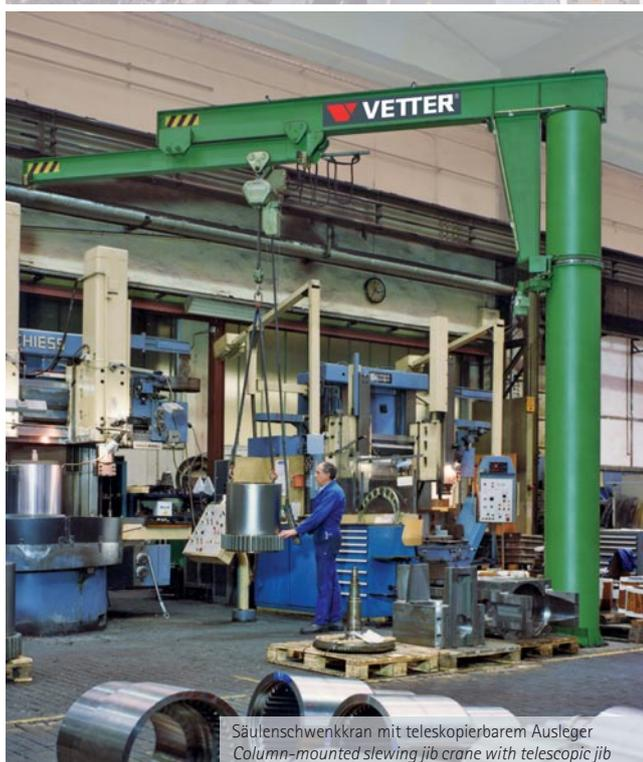
Säulenschwenkran mit teleskopierbarem Ausleger
