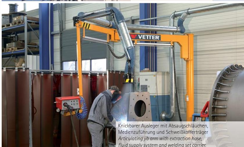
Knickbarer Ausleger mit Absaugschläuchen,
