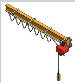
Robuste Stromzuführung, bestehend aus Flachkabel, Kabelwagen, C-Schiene und Haltearmen zur Befestigung am Ausleger. Kommandotafel am Hebezeug befestigt. Serienmäßig ab einer Ausladung von 10 m oder bei Verwendung mit elektrischem Schwenkantrieb.
