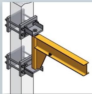
Zur Befestigung des Wandschwenkkranes an einer Stahlbetonstütze. Die vordere Konsolplatte wird mittels der zum Lieferumfang gehörenden Gewindestangen, Muttern und Gegenplatte an der Stütze verklemt.
