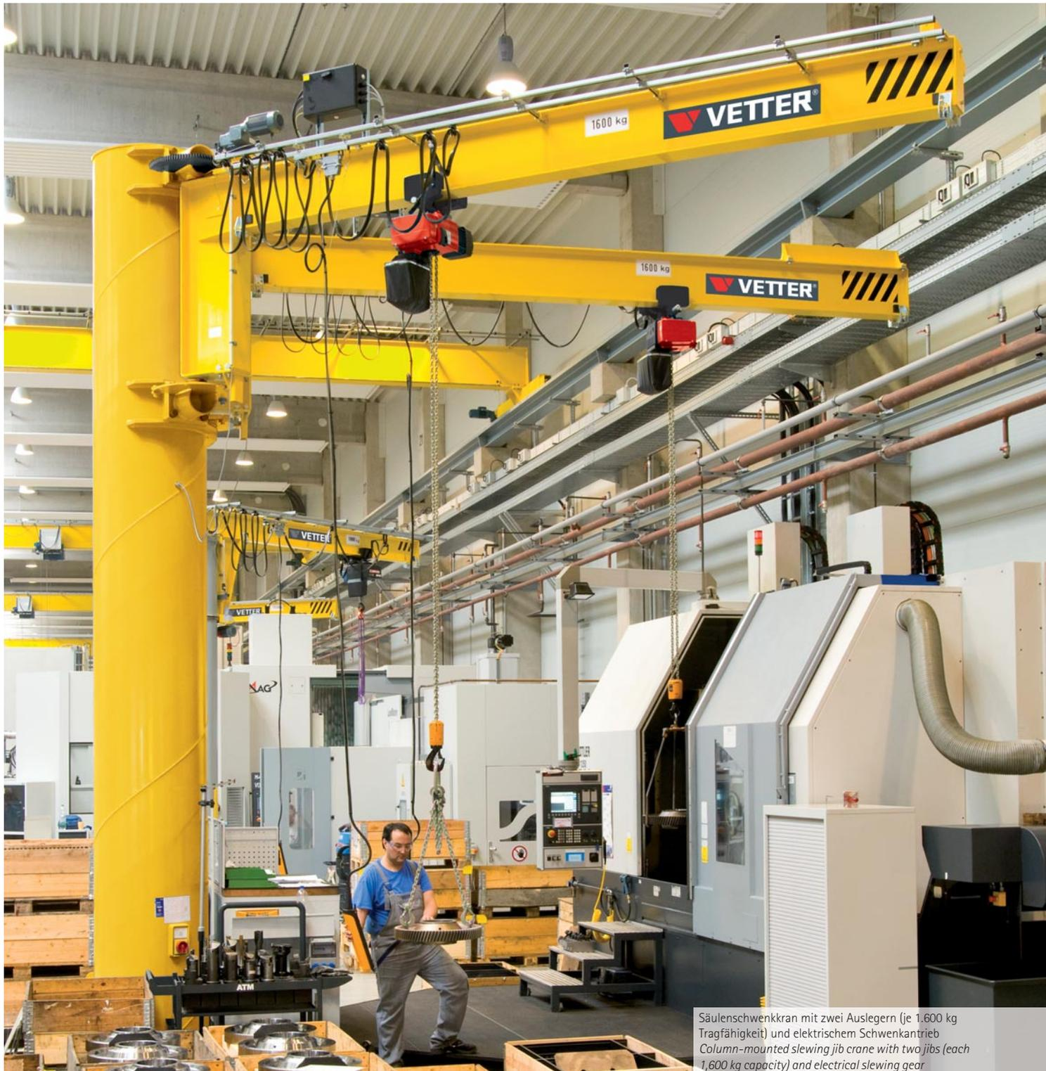
Säulenschwenkkran mit zwei Auslegern (je 1.600 kg Tragfähigkeit) und elektrischem Schwenkantrieb
