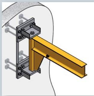
Zur Befestigung des Wandschwenkkranes an einer Betonwand. Die Konsolplatte wird mit den zum Lieferumfang gehörenden Gewindestangen, Muttern und Kontertscheiben an der Wand befestigt.
