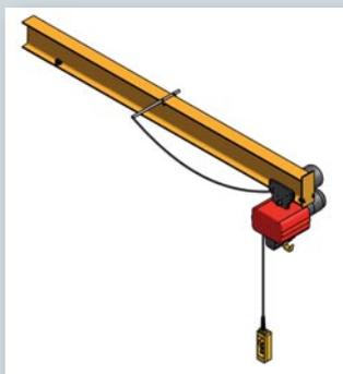
Stromzuführung über Kabelschleife, bestehend aus Rundkabel und Kabelhalterrohr zur Befestigung am Ausleger. Kommandotafel am Hebezeug befestigt. Geeignet bis zu einer Ausladung von 3-5 m\*.
