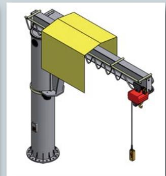
Wetterfeste Ausführung mit abgedichteten Lagern, Neoprenkabeln und Wetterschutzdach für Hebezeug und Schwenkantrieb. Bei Freigeländeeinsatz wird eine Feuerverzinkung der Stahlkonstruktion empfohlen.
