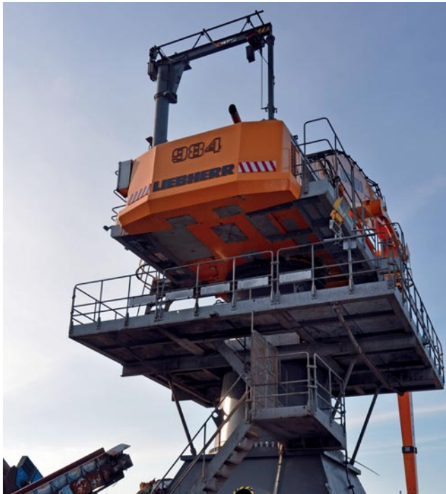
Wartungskran auf dem Gegengewicht eines Liebherr Hydraulikbaggers Maintenance crane on the counter weight of a Liebherr hydraulic excavator
